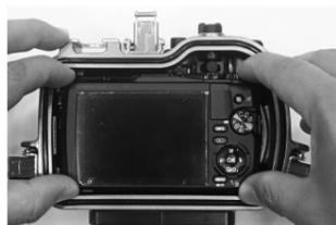
10. その時、ズームレバーの位置が真っ直ぐの状態に入れるようにしてください。カメラを入れたらハウジングのズームレバーを左右に動かして、カメラのズームレバーと噛み合っているか確認してください。
