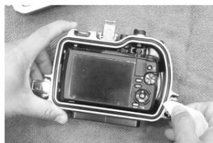
4. 同じくリアパネル側の溝の手前にも水滴が付いているので拭きとって下さい。
