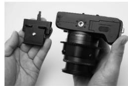
カメラ固定ベースの出っ張り(ポートロック)がカメラ前面方向になります。向きを間違えないように注意して、しっかりと取り付けてください。
