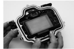
電源スイッチを上押し上げたままリアパネルを閉めます。
